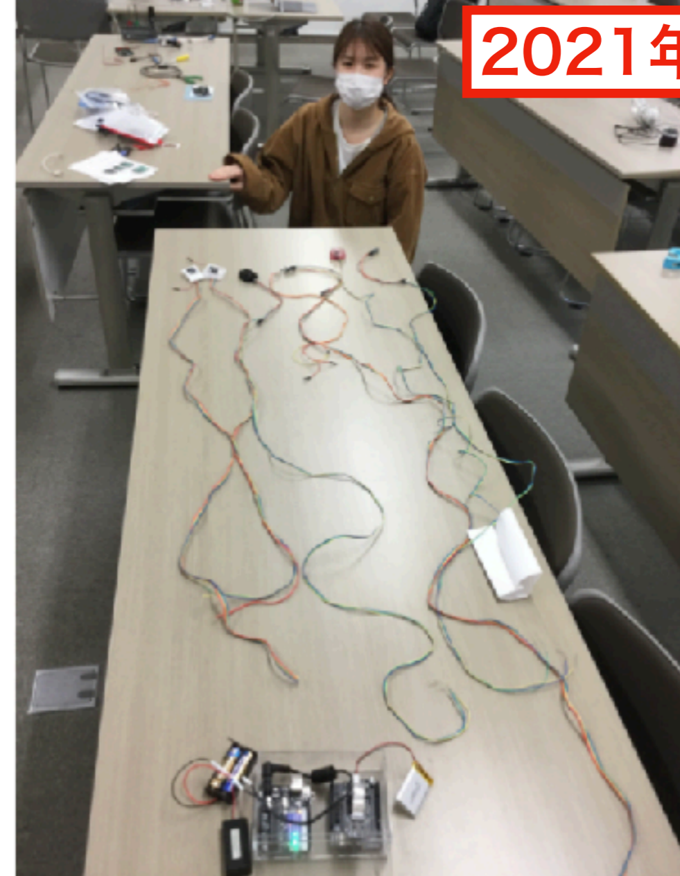
写真4：「妊婦さん陣痛タイミング予測センサー」で使う全部のセンサーをパッケージ化し、SpresenseもArduinoも電池駆動にして1個の箱に入れ、SDカードでデータ収集する段階までやりました。
